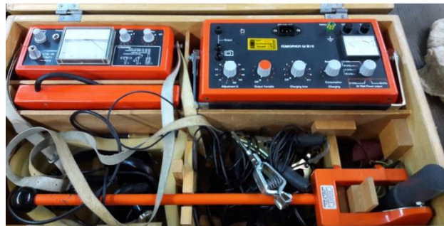
شکل ۴: استفاده از دستگاه عیب‌یاب کابل برای یافتن محل آسیب‌دیده
