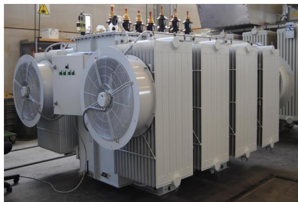
شکل ۳: ترانسفورماتور هرمتیک (بدون منبع انبساط)
